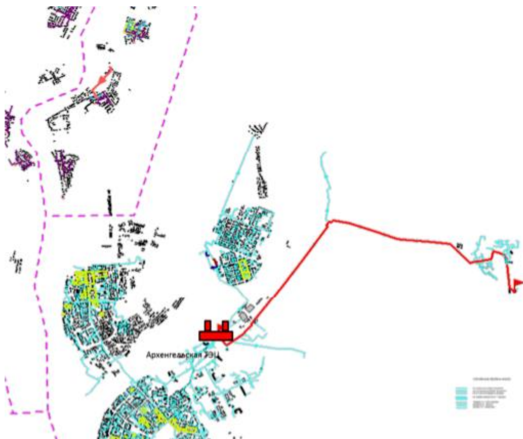
Рисунок 3.6 – Путь для расчёта вероятности безотказной работы тепловых сетей от Архангельской ТЭЦ до ТК-18т-4
